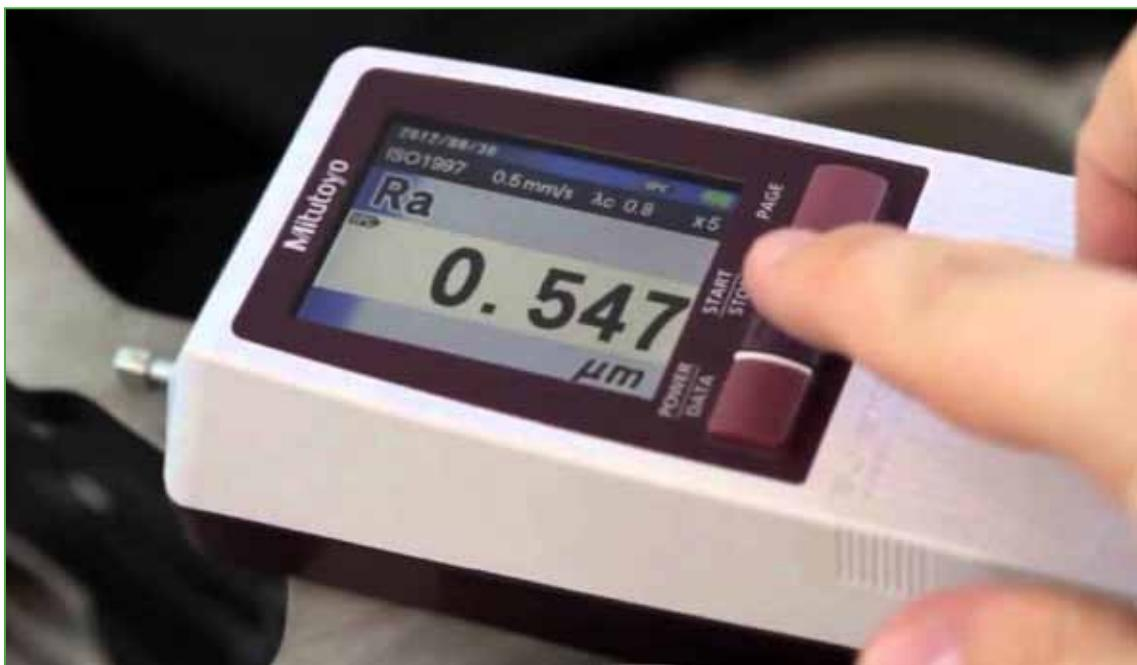
**Figura 2.** Rugosímetro MITUTOYO modelo SJ 210.
